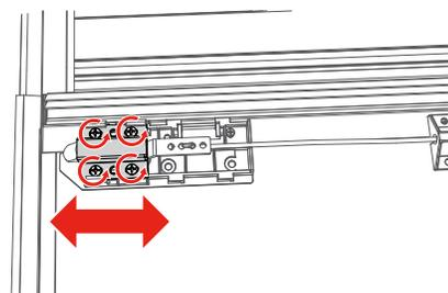
Lösen Sie bei abgenommener Verriegelungsabdeckung die Schrauben und verschieben Sie den Riegelhalter zum Einstellen. Ziehen Sie die Schrauben wieder an und schieben Sie das Riegelgehäuse wieder auf.
