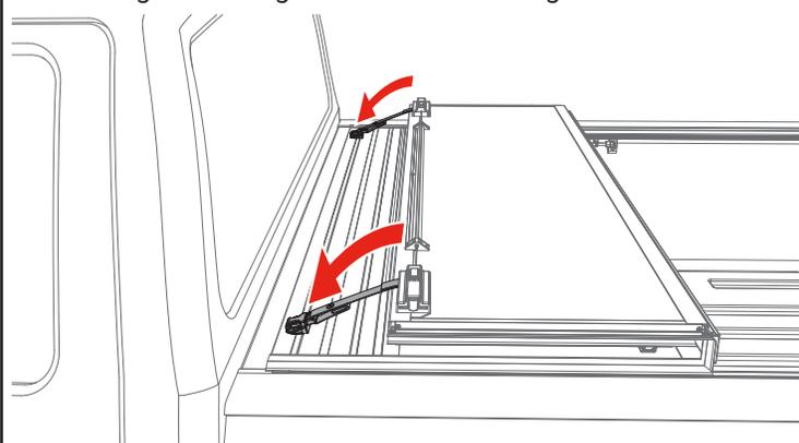
**AUFGEKLAPPTE STELLUNG:** Klappen Sie die Abdeckung (A) auf und heben Sie sie an, bis sie senkrecht zum Fahrerhaus steht. Lösen Sie dann die an der Seitenschiene angebrachte Stützstange und klemmen Sie sie an den Kugelbolzen an der Unterseite der Abdeckung fest.
