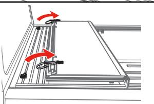
**ABDECKUNG SCHLIESSEN:** Um mit geschlossener Abdeckung (A) zu fahren, haken Sie die Schnallen und Bänder von der Schottwand los. Verstauen Sie die Bänder mithilfe der Klemmen an der Unterseite der zusammengeklappten Abdeckung. Klappen Sie alle Platten zur Ladeklappe hin und achten Sie dabei darauf, dass alle Riegel eingerastet sind.
