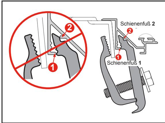
**Wassereintritt:** Sicherstellen, dass die vorderen Halteklemmen fest sind und korrekt in die Seitenschienen greifen. Darauf achten, dass die Schottichtung vorhanden ist und die Abdeckung darauf aufliegt. Sicherstellen, dass alle Riegel an den Seitenschienen eingerastet sind, und sie bei Bedarf justieren. Dafür sorgen, dass die Seitenschienen bündig mit der Oberkante der Ladeflächenschiene sind.
