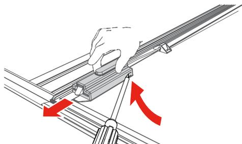
Falls eine Einstellung erforderlich ist, hebeln Sie mit einem Schraubendreher die Lasche am Riegelgehäuse teilweise auf. Schieben Sie das Gehäuse gleichzeitig weg von der Verriegelungsvorrichtung.
