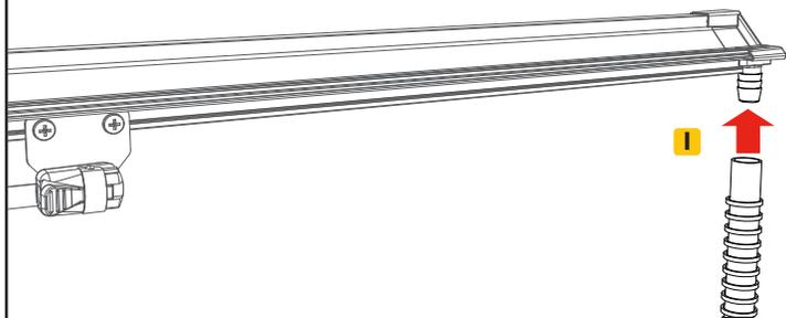
**6** **Ladeflächenabdeckung anbringen:** Schieben Sie vor dem Anbringen der Abdeckung (A) auf dem Fahrzeug zwei vordere Abdeckungshalteklammern (H) in die Bahn an der Unterseite der Abdeckung (A) in der Nähe des Fahrerhauses. Stellen Sie für einen optimalen Sitz sicher, dass die Halteklammern der Abdeckung richtig in der Abdeckungsschiene sitzen. Wiederholen Sie dies auf der gegenüberliegenden Seite der Abdeckung.
