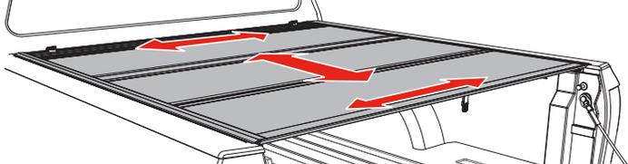
**Elektrische Ladeklappen:** Wenn Ihr Truck mit einer Ladeklappe ausgestattet ist, die sich elektrisch öffnen oder schließen lässt, stellen Sie sicher, dass die Ladeklappe bei geschlossener Abdeckung korrekt funktioniert, und justieren Sie bei Bedarf die Abdeckung zum Fahrerhaus hin.
