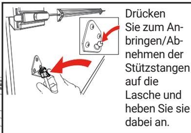
Drücken Sie zum Anbringen/Abnehmen der Stützstangen auf die Lasche und heben Sie sie dabei an.
