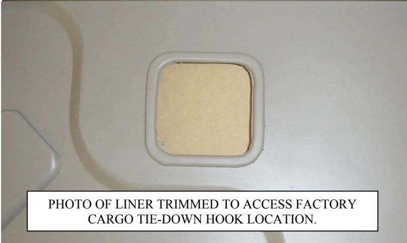
PHOTO OF LINER TRIMMED TO ACCESS FACTORY
