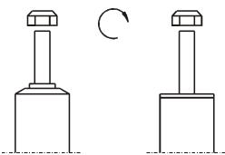
Um eine mögliche Zerstörung des Produktes zu vermeiden, darf zum Lösen und Anziehen der Muttern kein Schlagschraubendreher verwendet werden.
