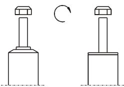
Um eine mögliche Zerstörung des Produktes zu vermeiden, darf zum Lösen und Anziehen der Muttern kein Schlagschraubendreher verwendet werden. Selbstsichernde Muttern dürfen nur
