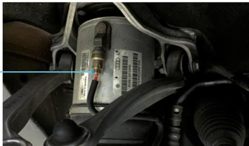
緩める時、残弁を適切な工具で固定してください。
